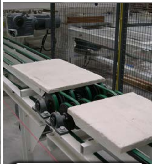
Automatischer Transfer der Produkte und der Formen Automatic product and mold conveying system
