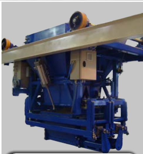
Befüllung der Form mittels automatischer Dosierung Automatic mold filling system
